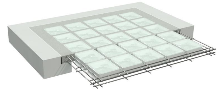
Oberseite einer horizontalen SGB-Platte (Außenseite)
